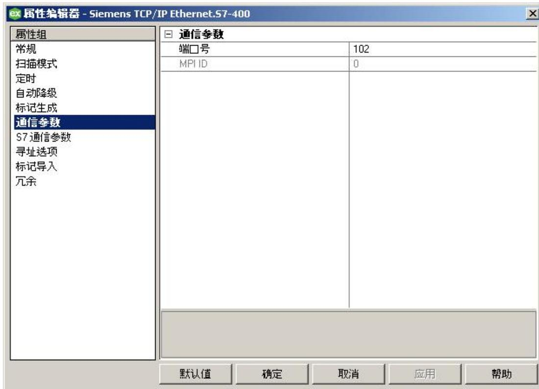
**“端口号”**: 此参数用于指定远程 CP 配置使用的端口号。IE TCP/IP 的默认设置是 102 (TSAP)。NetLink 的默认设置为 1099。
