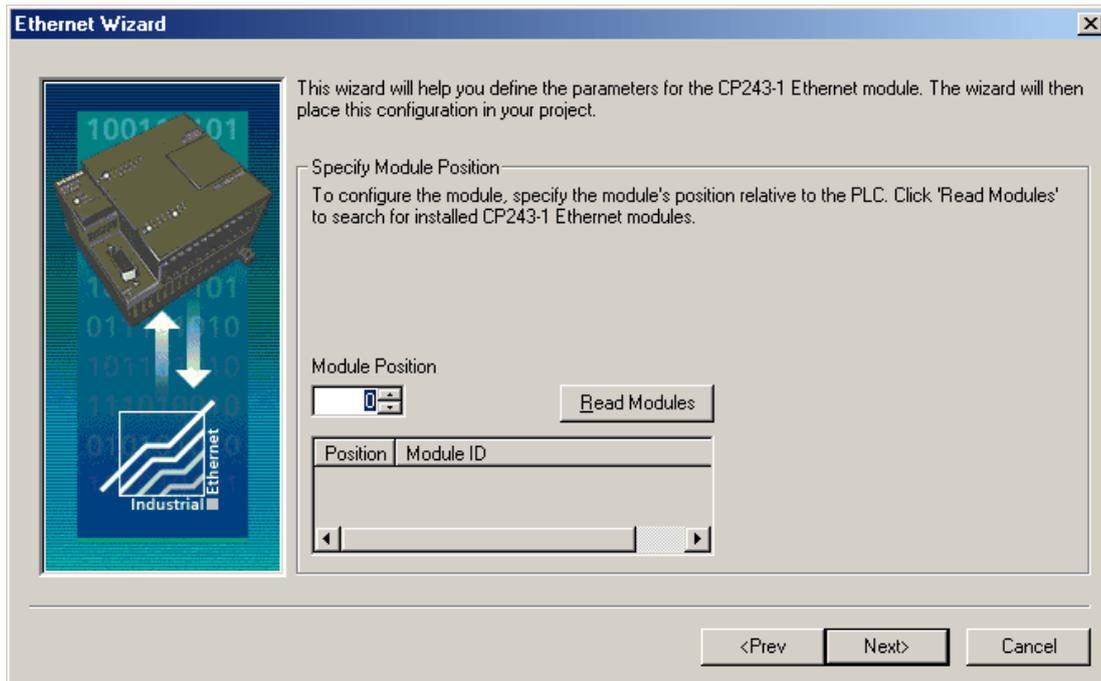
● **注意:** 虽然建议使用“读取模块”功能,但这需要将 PLC 通过串行端口或以太网连接到 PC。在任一情况下,均须正确设置 Micro/WIN 通信参数才能执行“读取模块”操作。
