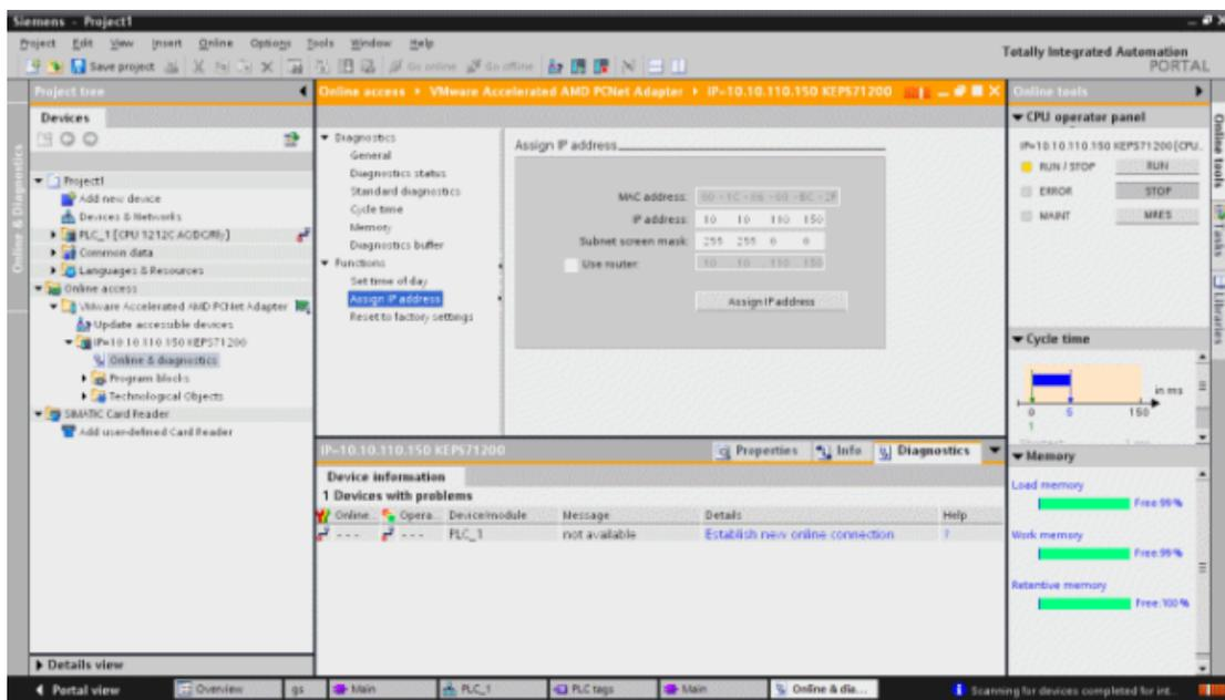
8. 输入通信设置，然后单击“分配 IP 地址”(Assign IP Address)。
