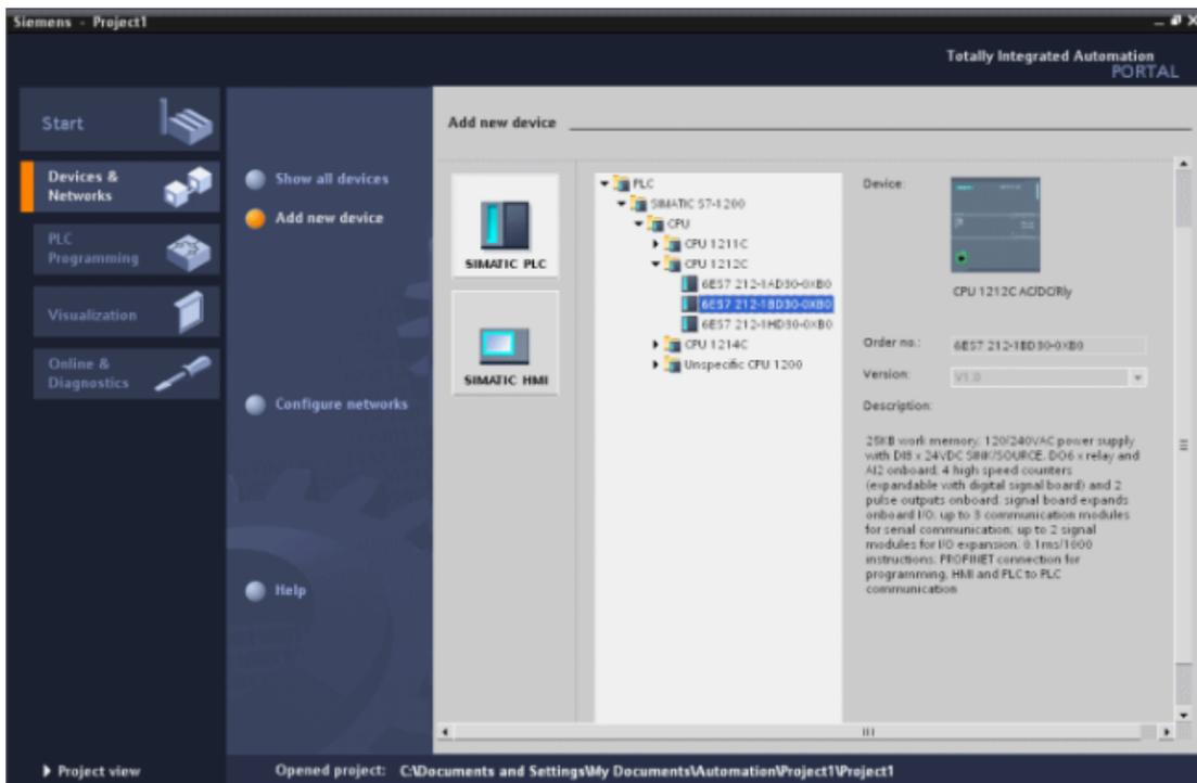
10. 接下来，选择设备的配置，然后单击“添加设备”(Add device)。此操作将调用“项目”视图，进一步配置设备硬件。
