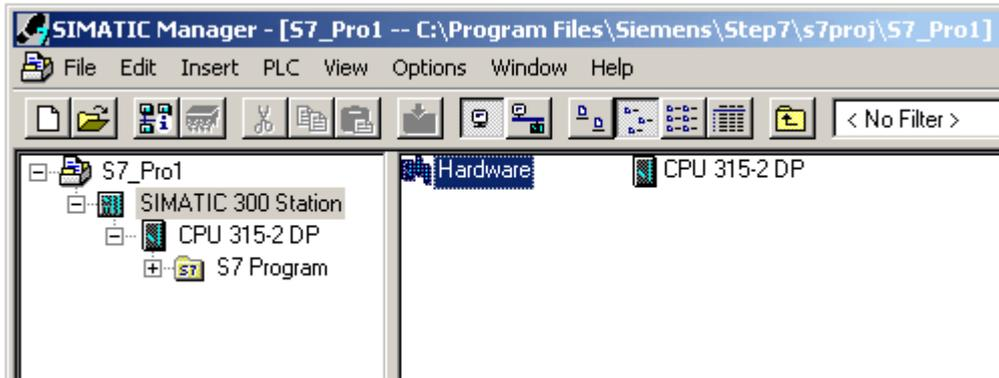
2. 如果是新 Simatic 项目，在“硬件配置”的“机架”中添加必要的模块。要在 Siemens TCP/IP Ethernet 驱动程序与 CPU 之间建立通信，至少需要一个支持“S7 通信”的以太网模块。这可能内置在 CPU 中。
