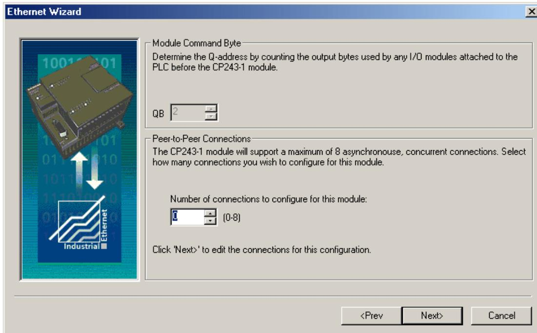
● **注意：**所选的连接数决定了 PLC 可支持的同时连接数。如果打算仅允许一台 OPC 服务器与 PLC 通信，请仅设置一个连接。这样可确保 OPC 服务器的最佳性能。如果打算与 PLC 建立多个活动连接，请使用多个连接。但请记住，使用每个连接都会影响模块的性能。
