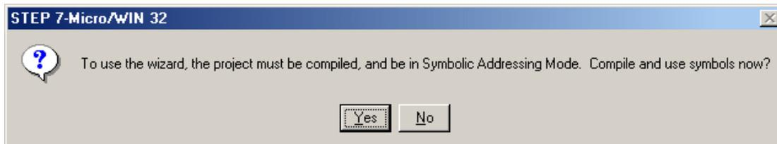
● **注意:** 必须先对程序进行编译, 才能执行以太网向导。请先纠正程序中的所有错误再继续操作。
