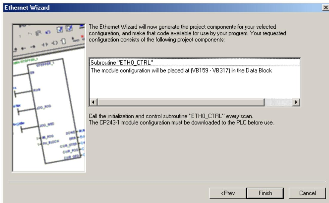
2. 要查看以太网向导生成的内容, 双击“程序块”(Program Block) 下的 **ETH0\_CTRL**。此外列出了所有已配置的 **TSAP** 以供将来参考。请记住, 下面的“本地 **TSAP**”其实是 OPC 服务器中的“远程 **TSAP**”, 下面的“远程 **TSAP**”其实是 OPC 服务器中的“本地 **TSAP**”。
