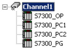
每个设备均出现在单一 Siemens TCP/IP Ethernet 信道下。在此配置中，驱动程序必须尽快从一个设备移动到下一个设备，以有效速率收集信息。随着更多设备的添加或从单个设备请求的信息的增加，整体更新速率会受到不利影响。
