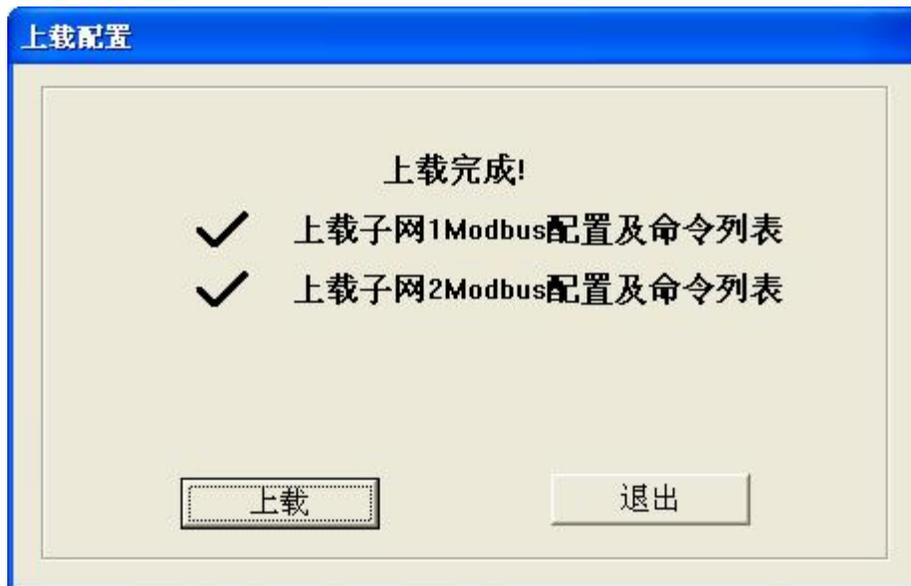
备注：在上载配置之前，请先检查“串口配置”中端口号是否为正在使用的串口。
