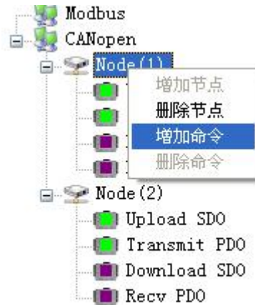
图 10 CANopen 增加命令和删除节点操作
