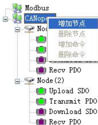
图 9 CANopen 增加节点操作
