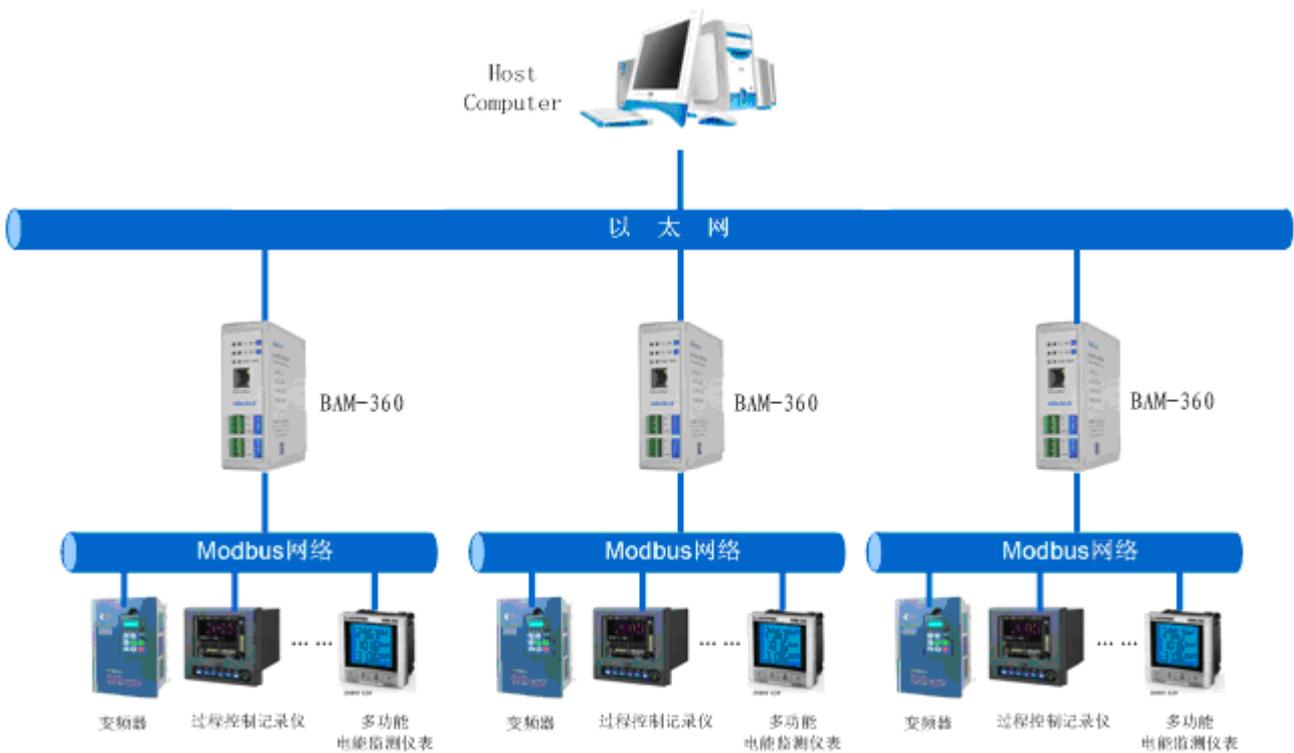
例如: 如上图多功能电能监测仪表是一个带 Modbus 从站接口的测量电流的表计, 其测量的电流值存储在地址 40001 处, 在 BM-123 中配置 03 号功能码, 寄存器起始地址为 0 (对应于 Modbus 寄存器 40001 地址), 然后 BM-123 会自动映射到 BACnet 对象 AnalogInput (模拟量输入), 在 BACnet 主站即 PC 上, 则通过对应的 AnalogInput 的值即可观测电流值。
