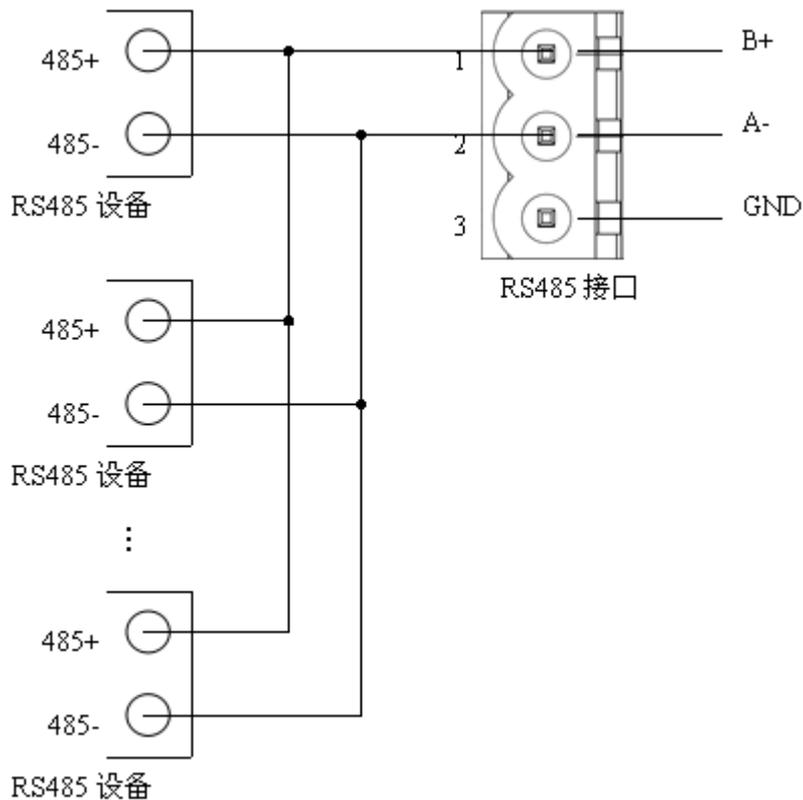
RS485 在点到多点通信时，为了防止信号的反射和干扰，需在线路的最远两端各接一个终端电阻，参数为 120Ω 1/2W。BAM-360 串口侧没有并联终端电阻。
